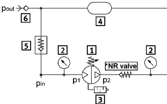
\* é enviado juntamente com o **MP100-2-04** uma válvula de retenção. Segue esquema de ligação ao lado.
