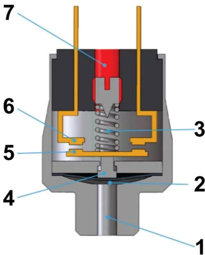
A pressão é aplicada ao diafragma/membrana (2). A membrana será empurrado pela pressão do fluido. Se a força da pressão exercida pelo fluido for maior do que a força da mola que está tensionada (3 - mola de ajuste) contra o diafragma, o conjunto mecânico (4) deve se mover na direção dos contatos elétricos (6), fechando o circuito entre os contatos elétricos.
